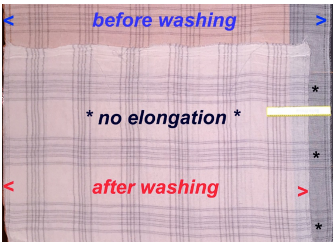
Figura 6 - Esempio allungamento tessuto lavato in KINETIKA
