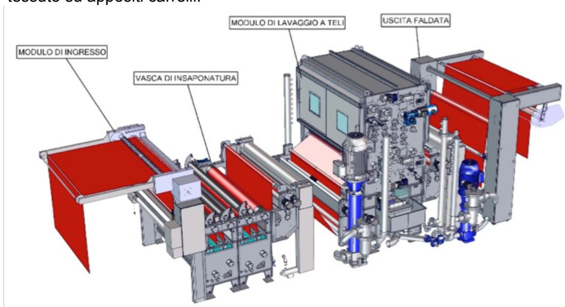
Figura 3 - Moduli linea di lavaggio KINETIKA.
