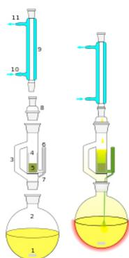
Fig. 5 – estrattore Soxhlet
