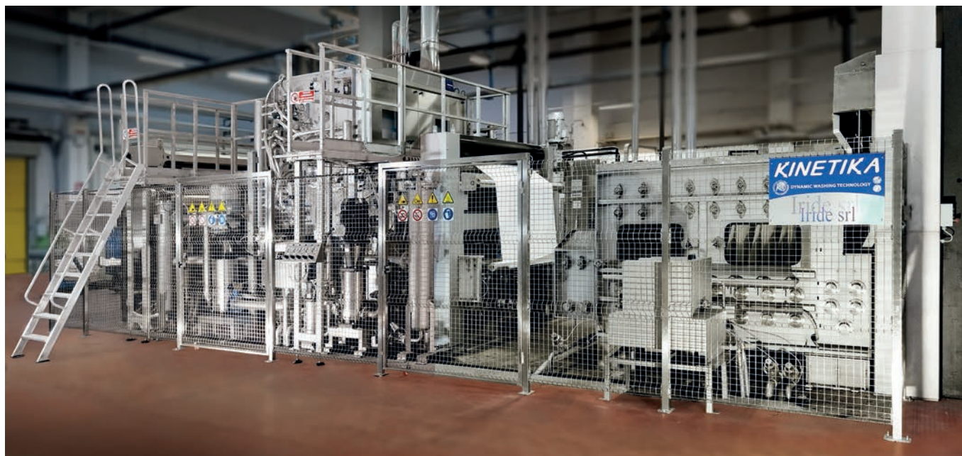
Sotto: Principio funzionamento Kinetika: getti ad alta pressione e nastri di trasporto del tessuto permeabili. Below: Kinetika operating principle: high-pressure jets and permeable fabric conveyor belts.
